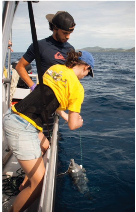
Échantillonnage d'une colonne d'eau ©Ifremer-H. Lemonnier
